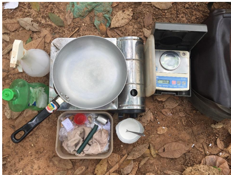
Hình 3.25: Dụng cụ xác định DRC tại vườn cây bằng phương pháp nung chảo
